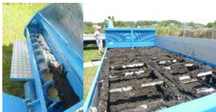
Figure 45 : Chaulage mobile de boues pâteuses □ Source : Simon Moos
