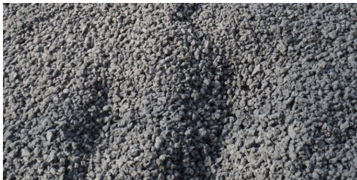
Figure 34 : Aspect des boues solides issues de serres solaires de séchage
