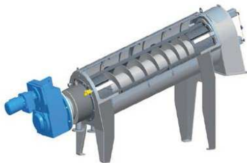
Figure 24 : Schéma de fonctionnement d'une presse à vis
