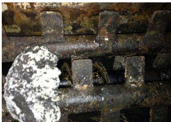
Figure 44 : Malaxeur à ailettes (permet le mélange de la chaux vive aux boues)
